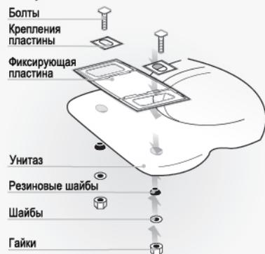
▶ Отрегулируйте фиксирующую пластину, чтобы совпали отверстия для болтов на пластине и унитазе.
